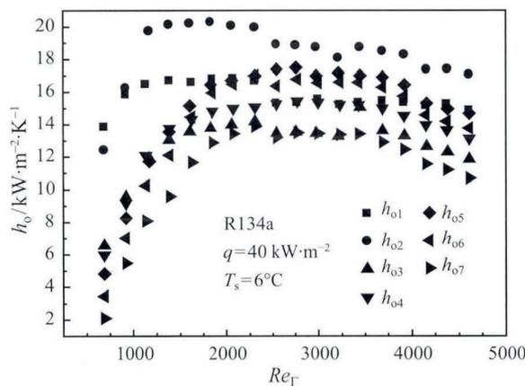
图 5  $q = 40 \text{ kW}\cdot\text{m}^{-2}$  时管外传热系数与液膜流量的关系
