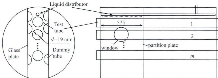
图 2 降膜蒸发器中实验管布置示意图
