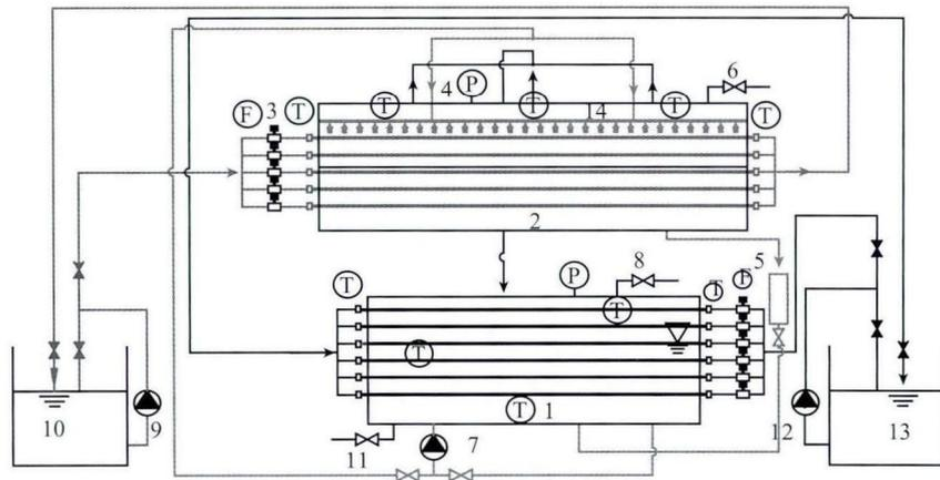
1. 冷凝器(制冷剂存储罐); 2. 蒸发器; 3. 电磁流量计; 4. 压力表; 5. 凝液量筒; 6. 放气阀; 7. 制冷剂磁力泵; 8. 制冷剂充注口; 9. 热水泵; 10. 热蓄水箱; 11. 排液阀; 12. 冷水泵; 13. 冷蓄水箱; 14. 布液器。
