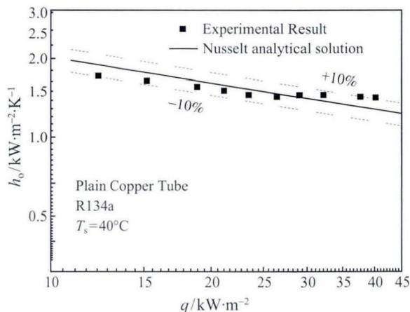
图 3 光管外凝结传热系数实验结果和 Nusselt 理论解的比较
