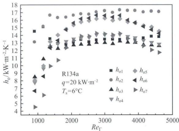
图 4  $q = 20 \text{ kW}\cdot\text{m}^{-2}$  时管外传热系数与液膜流量的关系
