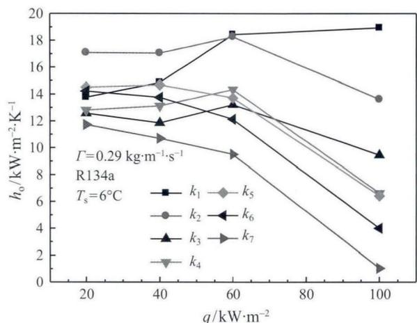
图 7  $\Gamma = 0.29 \text{ kg}\cdot\text{m}^{-1}\cdot\text{s}^{-1}$  时管外传热系数与热流密度的关系
