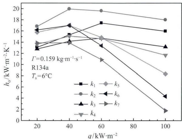
图 6  $\Gamma = 0.159 \text{ kg}\cdot\text{m}^{-1}\cdot\text{s}^{-1}$  时管外传热系数与热流密度的关系
