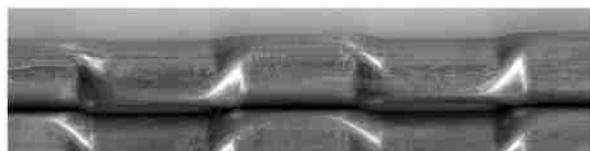
图 3 交叉缩放椭圆换热管
