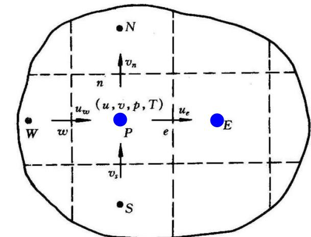
结构化的同位网格中MIM网格界面上  $u_e, \left(\frac{A_P}{a_P}\right)_E$  均采用线性插值计算公式
