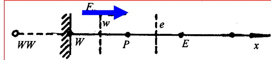
对邻近边界的内节点的界面可能找不到构建高阶格式所需的远邻点，建议采用降阶方法处理：
