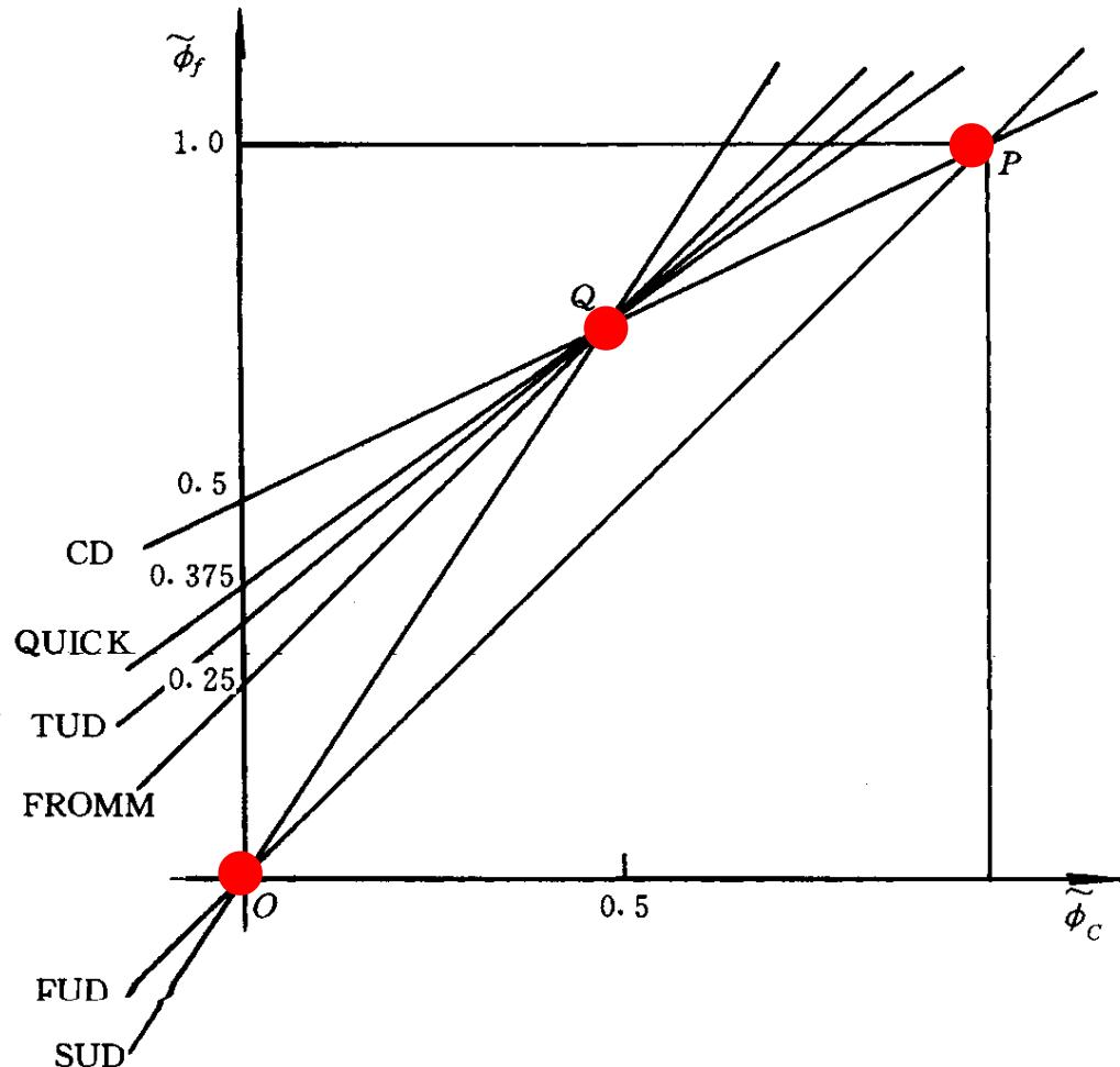
文献中已经提出了十余种将该三点连接起来的方案，称为组合格式 (**composite scheme**)。例如：
