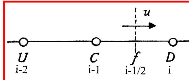
在非结构化网格中通过引入一个虚拟的节点就可采用以前的结果。
