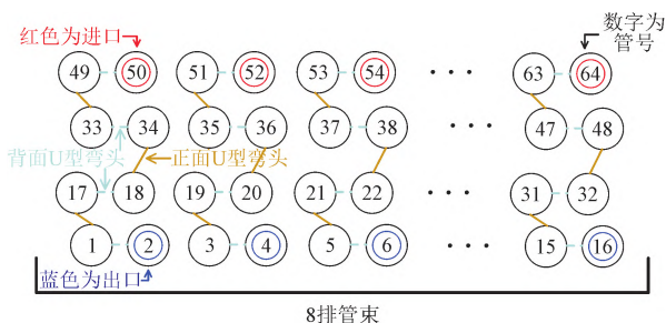
图 7 冷凝器管束结构
