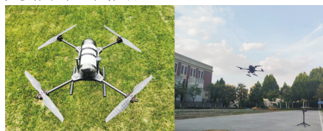
(a) 搭载氢动力系统的四旋翼无人机 (b) 氢动力无人机实飞图
